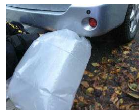
図5 排気ガスを集め水溶液にし、性質を調べる実験
