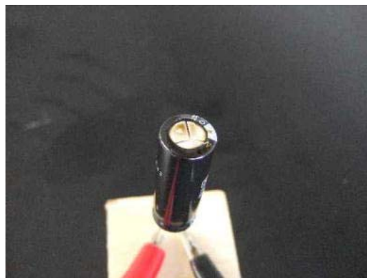
図17 破壊後の上部
