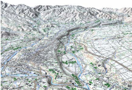
図25 撮影高度2138m, 撮影範囲21km, カメラの仰角-22°の状態で作成
