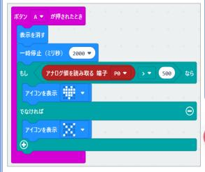
・お互いの手をつないで、下図のようにマイクロビットの端子を触りましょう。 A ボタンを押して、LED がハートになれば相性 OK。 二人の体を通じて流れる電気の量を判定して判断しています。 判定に使っている 500 という値を小さくすると、ハートが出やすくなって、大きくすると出にくくなります。 数値を変えて、試してみましょう。
