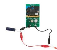
・理科ボードは、専用のバネプラグで、micro:bit と簡単に着脱することができます。ボードには、人感センサと電磁石を使ったスイッチが組み込まれており、「人を感知したら、スイッチを on にする。いなかったら off にする」といった動作をプログラムで簡単に作ることができます。
